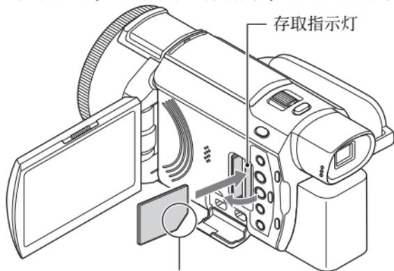
将凹角按如图所示的方向插入卡。
