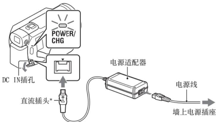
\* 将直流插头上的▲标记对准DC IN插孔上的标记。
